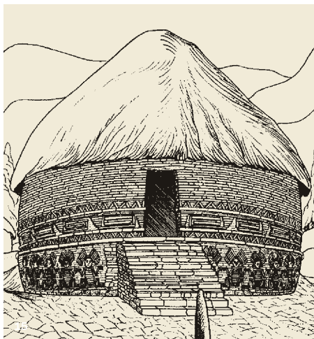
◀ Fig. 15. Reconstrucción del techo del Recinto 1 del Gran Pajatén, Se estima que estuvo conformado por un armazón cónico sobre el que se sujetaba una techumbre de paja.
