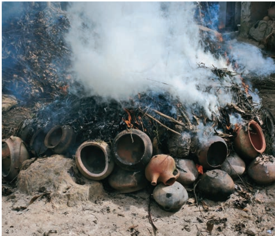
◀ Fig. 2. Horno para la cocción de la alfarería en espacios abiertos que aún se practica en el pueblo de Huancas, provincia de Chachapoyas.
